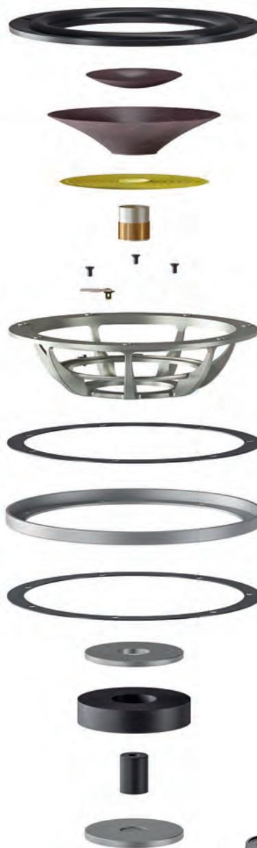
◀ In der Explosionszeichnung wird einmal mehr der komplexe Aufbau eines hochwertigen DALI-Basstreivers sichtbar.
