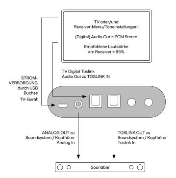
Falls Ihr Fernseher über keinen "Digital Audio Out/Toslink" mit PCM Signal verfügt, empfehlen wir die Nutzung eines "Analog zu Digital Toslink" Konverters, um den analogen Ausgang Ihres TV mit unserem Gerät zu verbinden.
