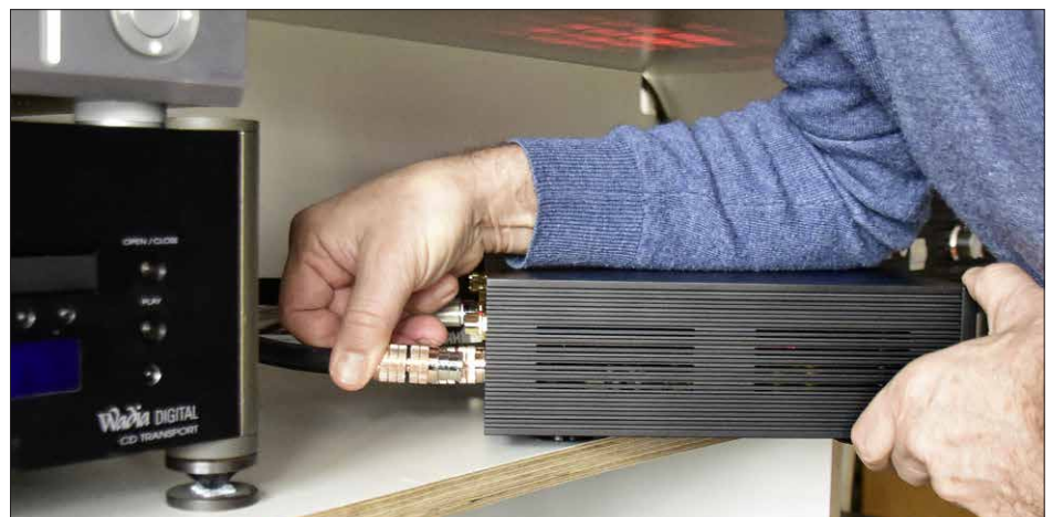
Übersicht nicht verlieren: Neben den zahlreichen digitalen Ein- und Ausgängen finden sich an der Rückseite auch Analog-Ein- und -Ausgänge jeweils in Cinch und XLR.
