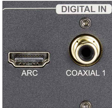
Im Gegensatz zum kleineren DMP-A6 verfügt der 8er auch über einen ARC-Eingang fürs TV.
