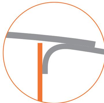
Das Gesamtergebnis dieser konstruktiven Details ist ein 150 mm (6 Zoll) Tiefmitteltöner mit einer Bautiefe, die weniger als die Hälfte eines konventionellen Chassis beträgt. Die akustische Leistung in Bezug auf Frequenzgang, Verzerrung und Kompression ist im Verhalten der Membranen sehr vergleichbar.
