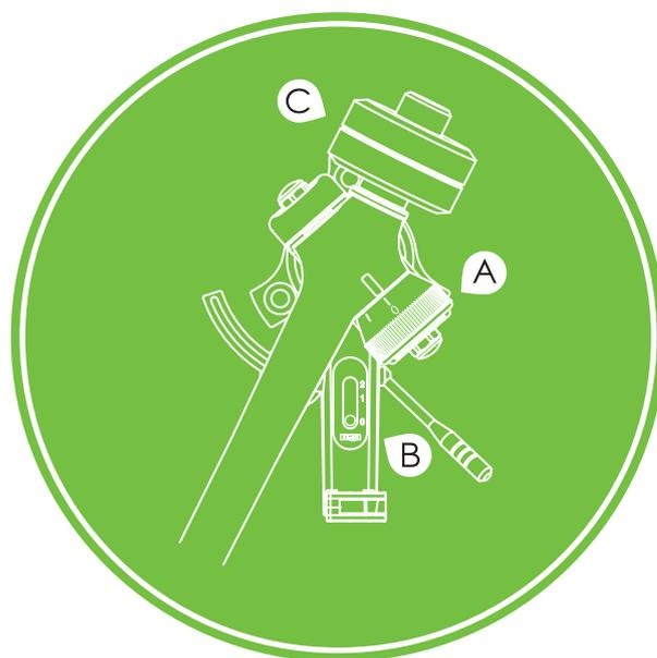
Die vorgesehene Auflagekraft kann nun an dem Rad (A) eingestellt werden. Es ist sinnvoll, eine Zahl am oberen Ende des empfohlenen Bereichs zu wählen. Dann wird die Skatingkompensation (B) auf denselben Wert eingestellt.
