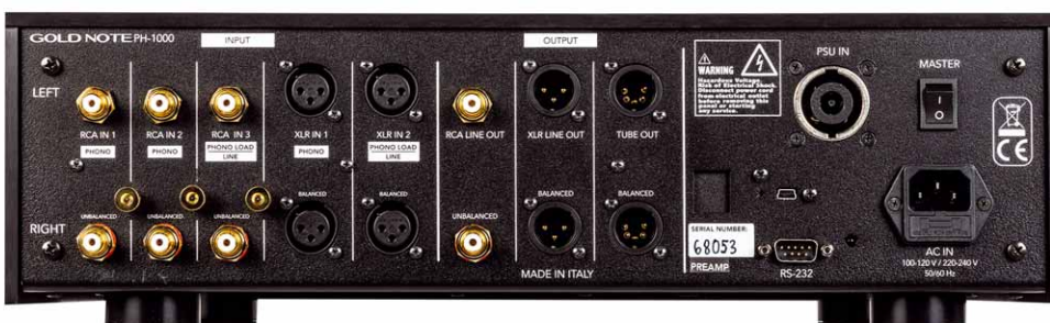
Reichlich Buchsen für ein Phonovorstufe. Zwei Eingänge können auch als Hochpegelanschlüsse fungieren
