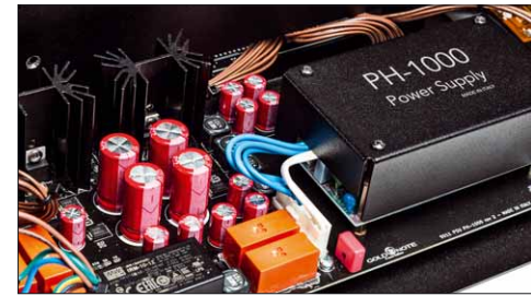
Unterm Metalldeckel sitzt ein Schaltnetzteil zur Speisung
