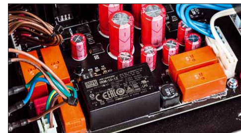
Ein zweites Schaltnetzteil hält Teile der Digitaltechnik im Standby-Modus „am Leben“
