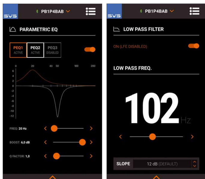
Die App ermöglicht weitreichende Konfiguration von Amplitude und Phase, dazu gibt es praktische Einstellmöglichkeiten für Beleuchtung, Einschaltautomatik und Setups
