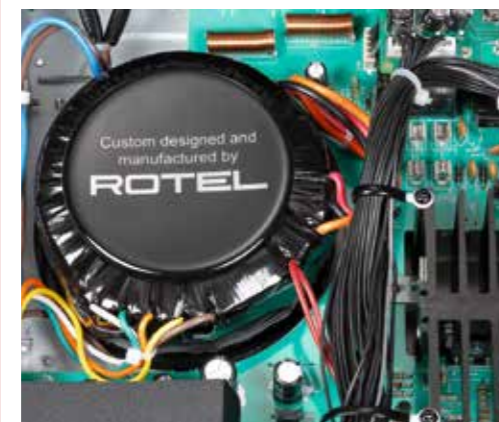
Der Ringkerntrafo des A11 ist Rotel-typisch großzügig dimensioniert und wird im eigenen Werk unter strengen Qualitätsansprüchen gefertigt.
