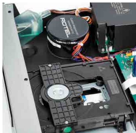
▲ Schubladenlaufwerk und ein reichlich dimensionierter Ringkerntrafo im CD-Spieler
