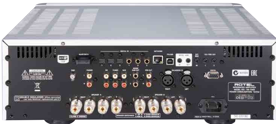
▲ Diverse Digital- und Analogeingänge inklusive XLR, zwei Lautsprecherpaare getrennt schaltbar
